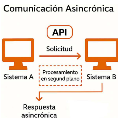
Ilustración 2. Diagrama ejemplo de comunicación asincrónica
